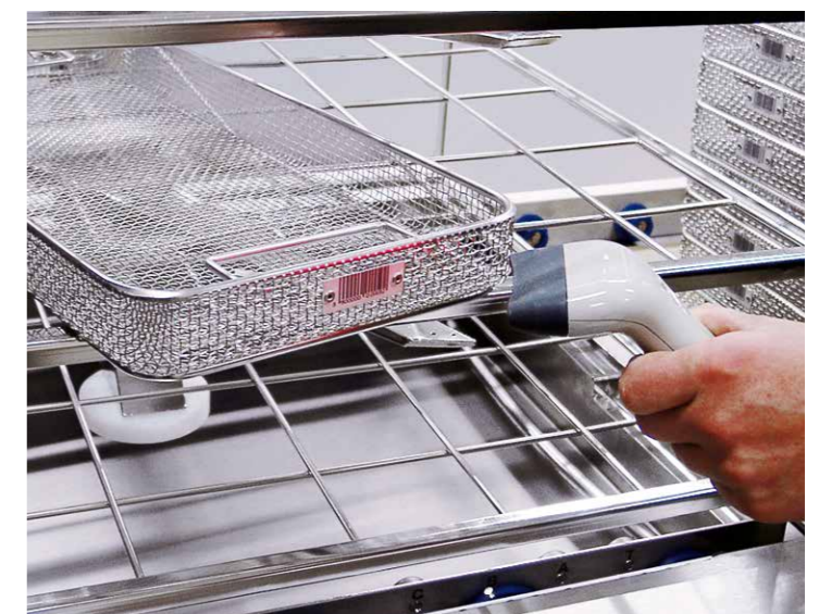
Der Barcode-Scanner von Belimed ermöglicht die schnelle Erkennung der Siebschalen der Instrumente
