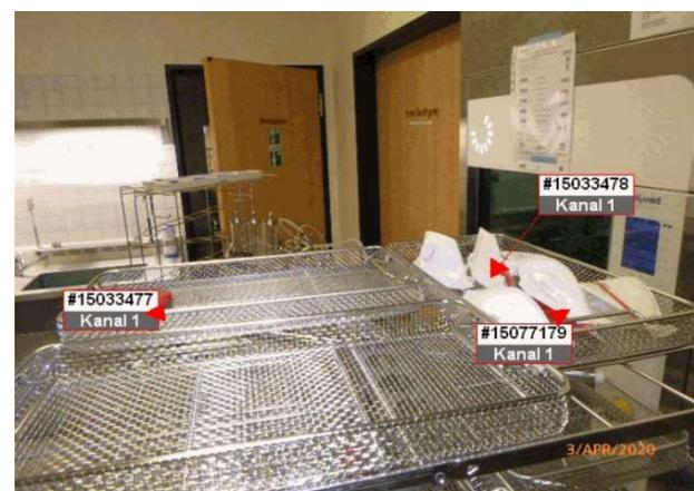
Foto 9: Nivel superior del estante de cuatro niveles con máscaras FFP2 frente a la lavadora-desinfectadora Belimed WD 290.
