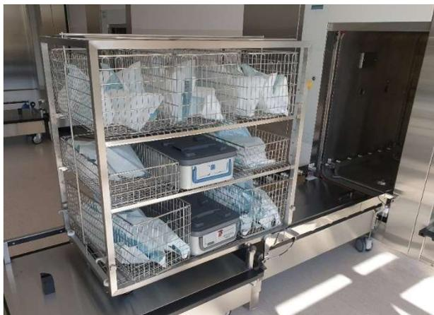
Foto 2: Lote de esterilizadores con máscaras FFP2 para descontaminación junto con otras cargas adecuadas para este proceso de esterilización
