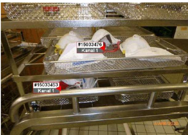
Imagen 8: Rack de cuatro niveles con máscaras FFP2 y registradores de temperatura en varios niveles
