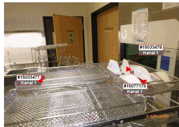
Photo 8 : Niveau supérieur d'un rack à quatre niveaux avec des masques FFP2 devant le laveur-désinfecteur Belimed WD 290
